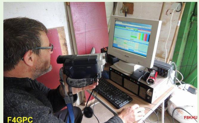
Le TX DATV est un DIGILITE de G8AJN sur 436MHz avec 2MHz de bande passante et un hybride RA30H4047 pour 30W HF, le tout en standard DVB-S.
