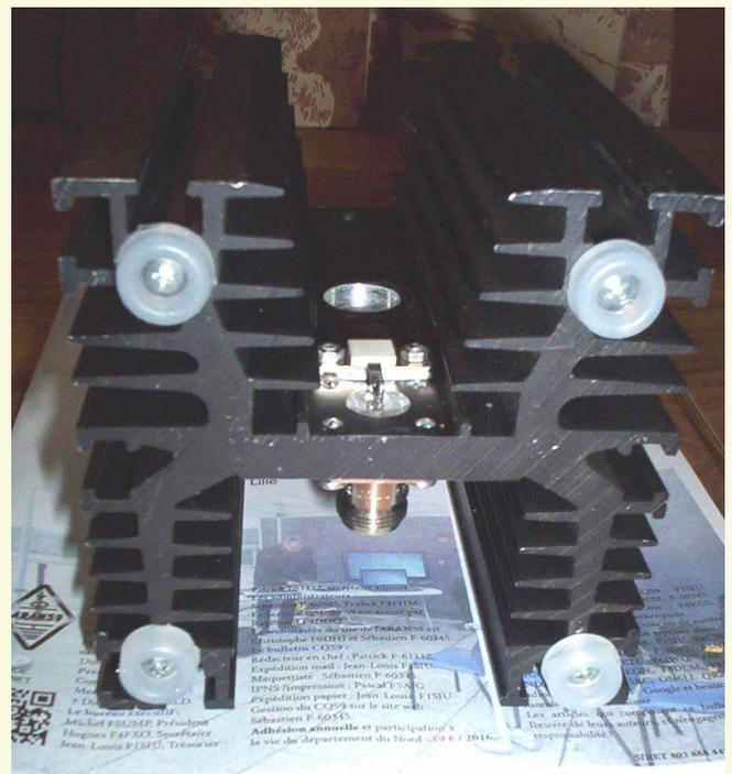
On pourrait imaginer un essai plus long, mais en prenant la température sur la résistance. Il faudrait disposer d'une tension de 100 V délivrant au moins 2 A. Une tension alternative à partir du 240 V, d'un vario associé à un transfo d'isolement [3] pourrait permettre ce type d'essai, à condition d'isoler le radiateur de l'OM !
