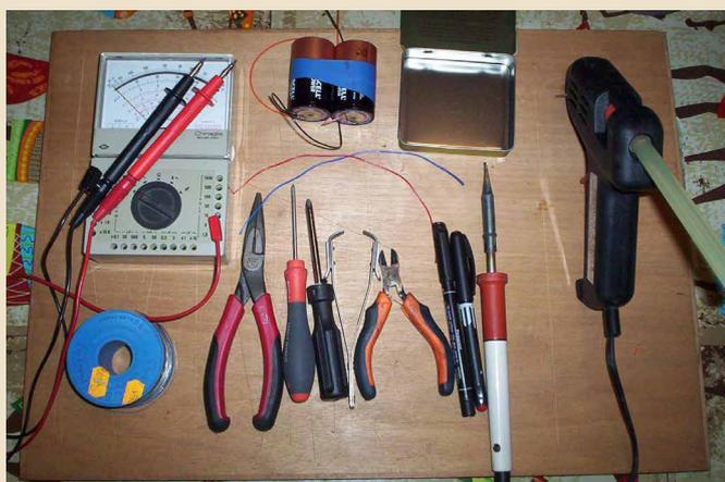
J'ai utilisé 2 piles de 1,5 V neuves. La mise en série a été réalisée avec du petit fil de câblage multibrins, directement soudé sur les piles. Ceci pour éviter toute coupure malencontreuse avec
