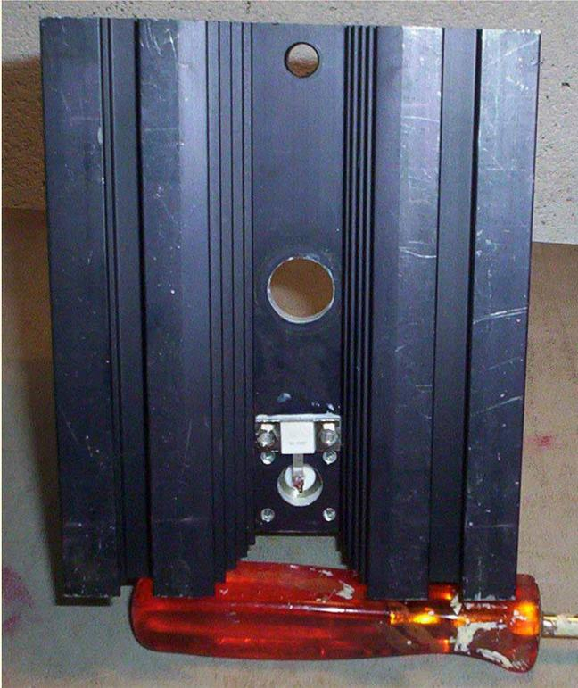
Un des côtés du socle du connecteur a été pré-étamé, avant fixation, un fer à souder de 200 ou 300 W aurait été nécessaire. Pour ma part j'ai utilisé deux fers de 70 W et quatre mains...
