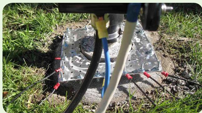
Il faut un plan de sol correct. L'ajout de radars est indispensable pour le bon fonctionnement, il va de soi. Pour ma part j'ai installé 47 radars, de longueurs de 1,50 m à 5 m
