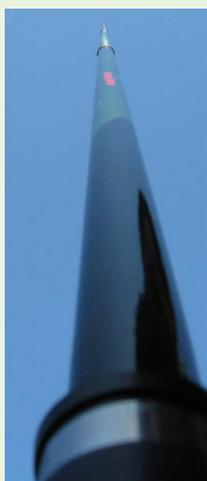
Je vais vous parler de l'antenne verticale steppIR qui couvre les bandes du 6 m au 20 m, en 1/4 d'onde (SmallIR). Cette antenne est motorisée, déroulant un ruban à l'intérieur d'une canne en fibre.
