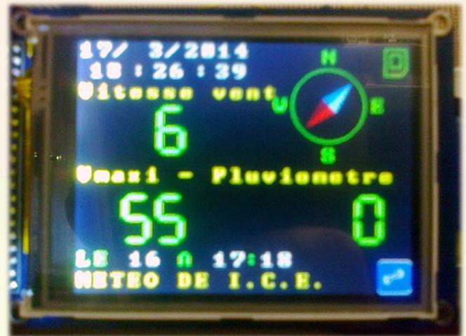
La station est bâtie autour de deux microcontrôleurs ARDUINO(1). Ces microcontrôleurs, issus de la société ATMEL, sont programmables à travers un logiciel open source gratuit, édité par une société italienne.
