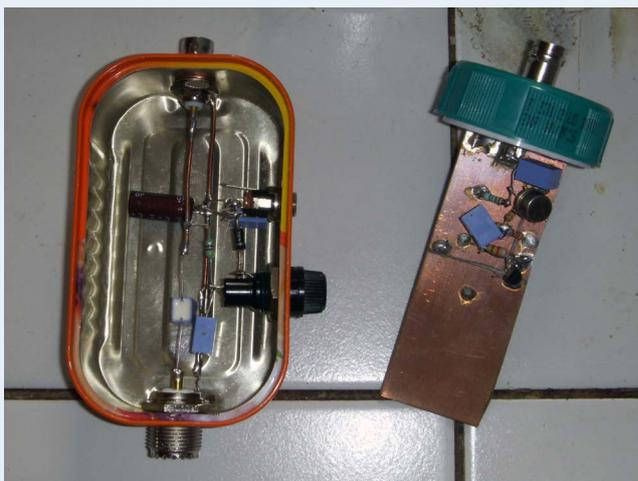
Le choix des transistors n'est pas critique, il faut simplement que le transistor bipolaire ait une fréquence de transition (produit Gain X Fréquence, ou plus simplement fréquence où le gain est unitaire) élevée, car la bande passante d'un mon-
